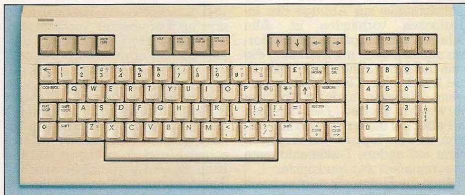
Bild 4. Die Tastatur ist funktionell und ergonomisch aufgebaut. Der deutsche Zeichensatz wird durch die Umschalttaste ASCII/DIN erreichbar. Die Belegung der Tasten entspricht dann den DIN-Normen. Die Bezeichnungen sind bereits auf den Tastenkappen aufgedruckt. Durch diesen Zeichensatz ergibt sich teilweise eine fünffache Belegung einzelner Tasten. Doch diese Tatsache wird dann gerechtfertigt, wenn es speziell auf den deutschen Markt zugeschnittene Textverarbeitungsprogramme geben wird (und vielleicht auch einen Drucker von Commodore, der die deutschen Umlaute von Haus aus beherrscht).
